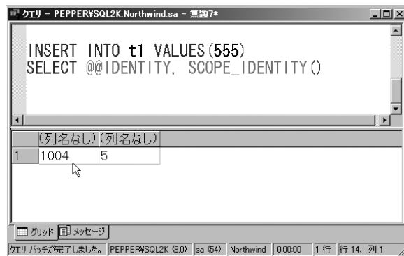
図3：@@IDENTITYはトリガ内で生成されたIDENTITY値を取得してしまう
